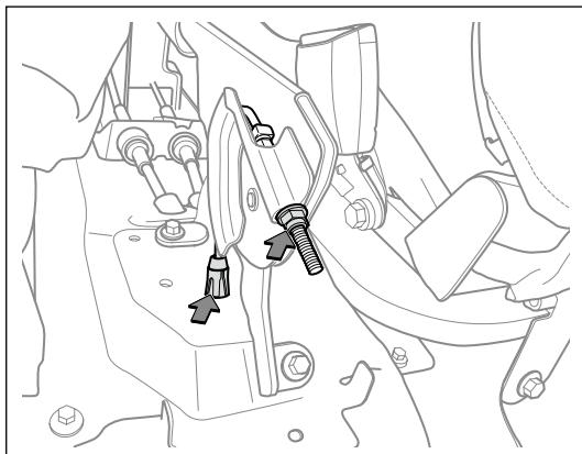
1. **拆卸驻车制动拉索**
