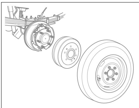
(i). 拆卸后车轮固定螺母，并依次取下后车轮与后轮鼓。
