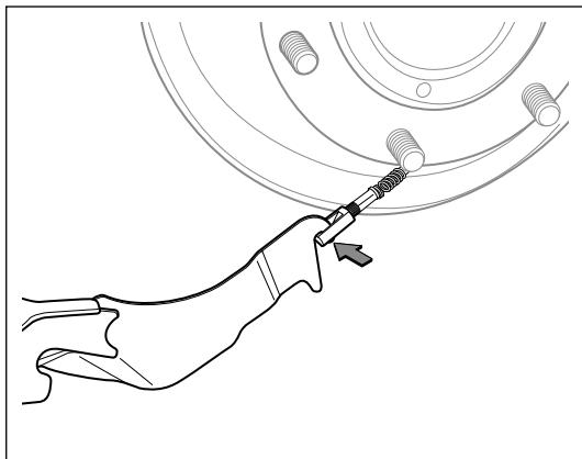
(m). 反转制动蹄片摘下制动拉索。
