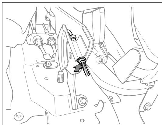
1. 调整驻车制动操纵机构
