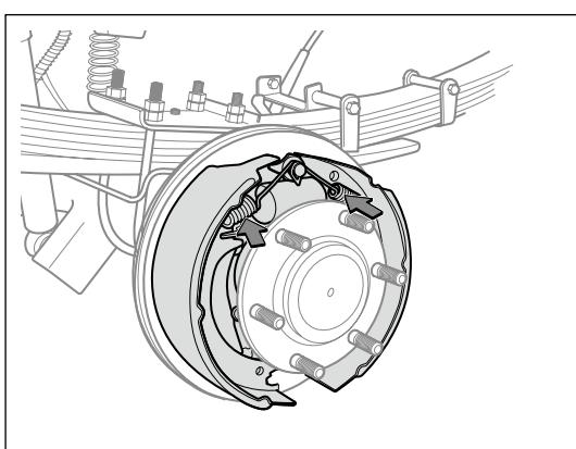
(l). 拆卸后制动蹄片上弹簧，并依次取下制动蹄挡片及垫片、上支撑及弹簧、前后制动蹄。
