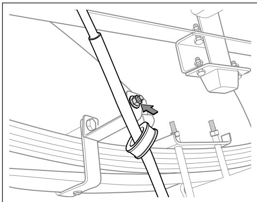
(h). 拆卸驻车制动拉索支架固定螺母。
