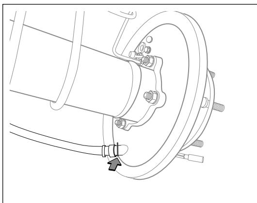
(n). 拆卸制动拉索卡簧，拔出制动拉索。
